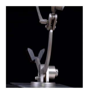
El anillo extraíble del cabezal permite el giro de 360º para el corte de maza, babilla o 3º corte con un giro suave y uniforme.
